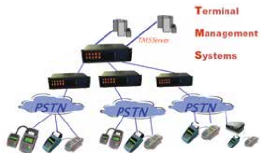
شماتیک سیستم بانکی و خدمات
